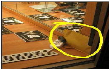
Figura II-41 : Sistema B-MAD - sensor Bluetooth colocado junto a vitrina de uma loja.
