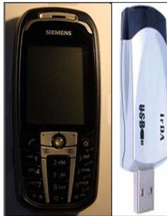
Figura II-16: Dois dispositivos móveis que usam a tecnologia de Infravermelhos.
