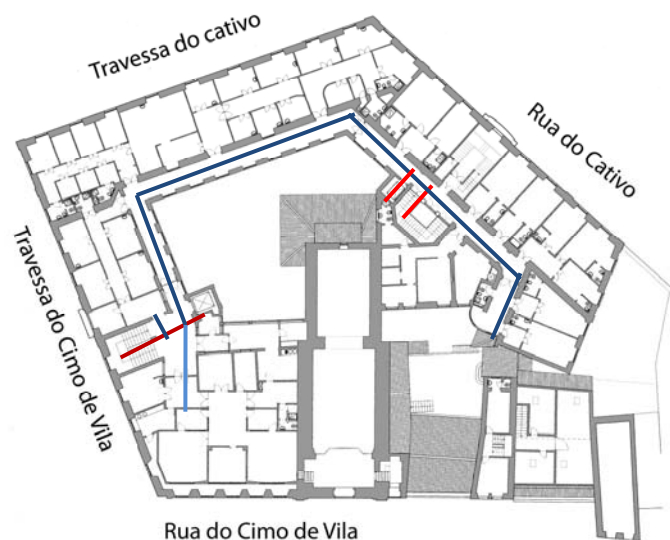
Figura 58 – Fluxos funcionais, piso 2
