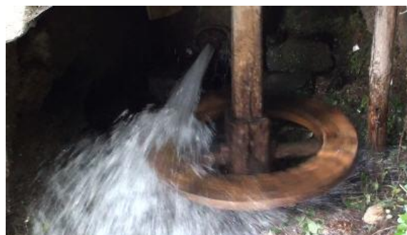
figura 14: em cima: rodízio do moinho da Ribeira; em baixo: água a esguichar pela setia – FONTE: foto de Henrique Gonçalves
