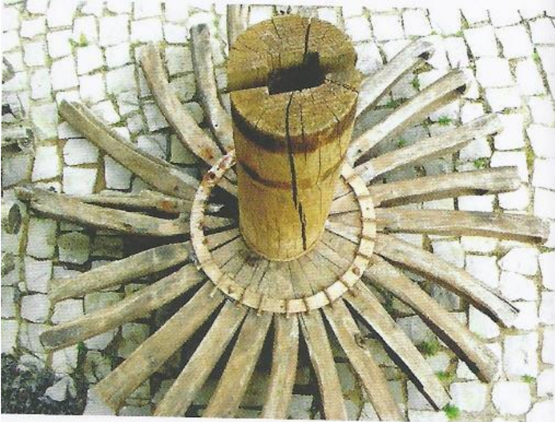
figura 29: Rodízio com penas de madeira. Moinho de Paderne, Albufeira. FONTE: Ribeiro, V. et al (2008) p.146
