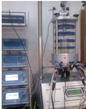
Figura VII-13- Equipamento de ensaio Triaxial
