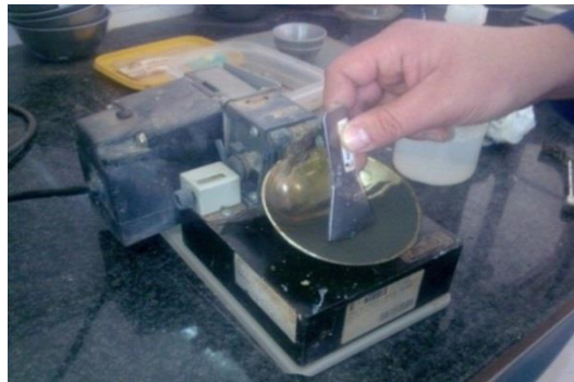
Figura VII-2- Verificação da altura de material do limite de liquidez
