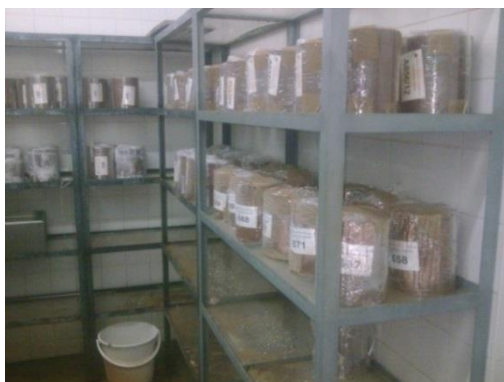
Figura VIII-3 - provetes acondicionados em câmara controlada
