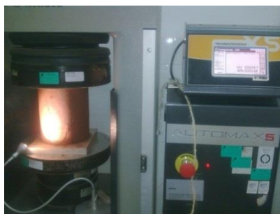
Figura VII-15 – Ensaio de compressão simples
