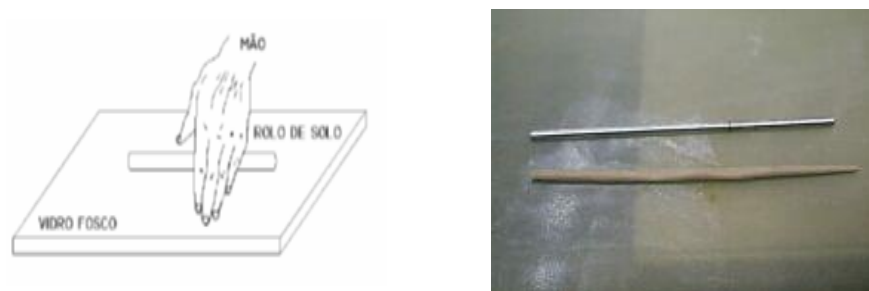
Figura VII-4 – Ensaio Limite de Plasticidade
