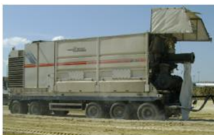
Figura V-2 - Espalhamento mecânico de ligante
