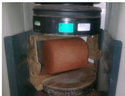
Figura VII-16 – Ensaio de compressão diametral
