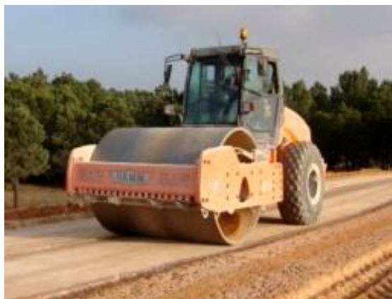
Figura V-5 – Cilindro de rasto liso
