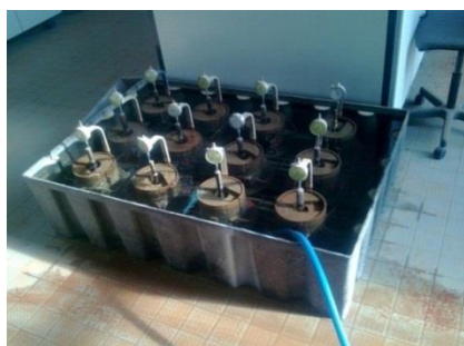
Figura VII-11 - Imersão de provetes C.B.R.
