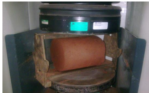
Figura VIII-5 - Ensaio de compressão Diametral
