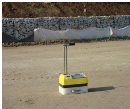
Figura VII-18- Ensaio de gamadensímetro ou núcleodensímetro
