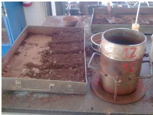
Figura VIII-2 - Moldagem de provetes
