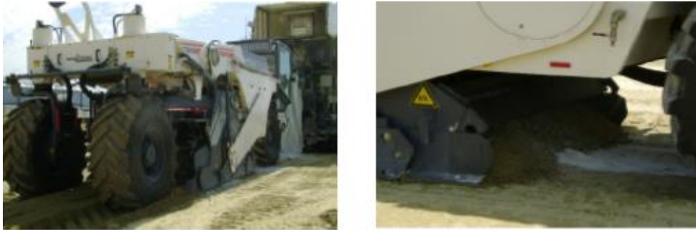
Figura V-4 - Misturadora mecânica Wirtgen (WR 2000)
