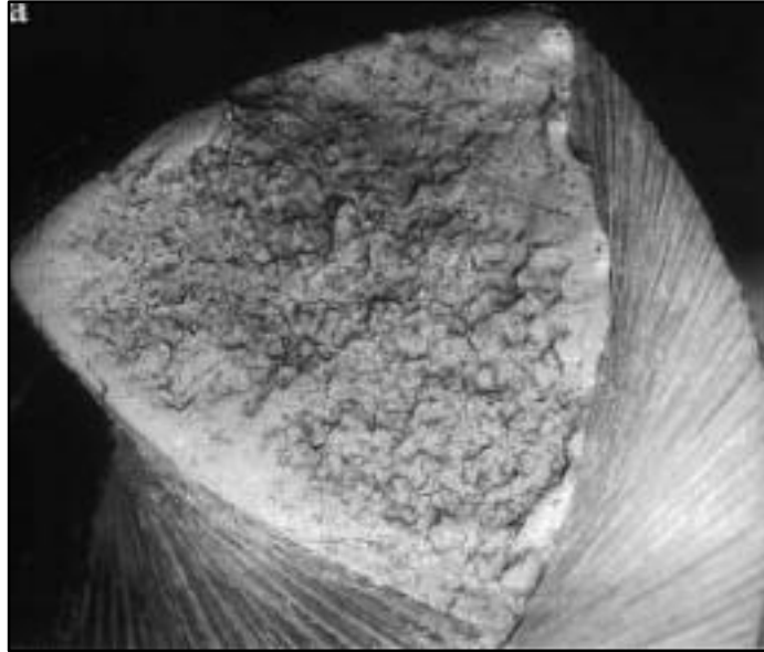
Figura 6: Lima ProTaper fraturada (Spanaki-Voreadi P, et al., 2006)
