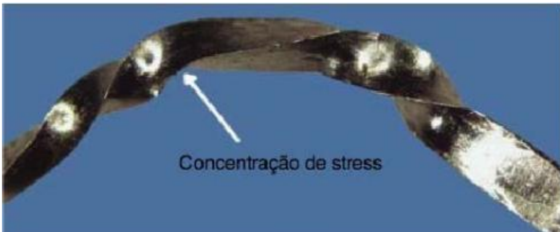
Figura 7: Concentração de stress na lima após instrumentação (McSpadden, 2006)
