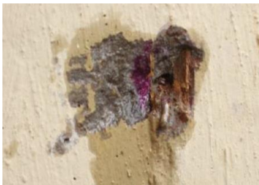
Figura 1- Teste com fenolftaleína (MOUTINHO, 2016).
