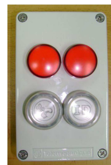
Figura III.17. Caixa para introdução de eventos colocada na traseira da viatura (COMPTA, 2011).
