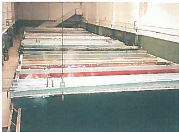
Figura IV.1. – Linha de anodização na empresa Alumínios Ibérica, Lda.
