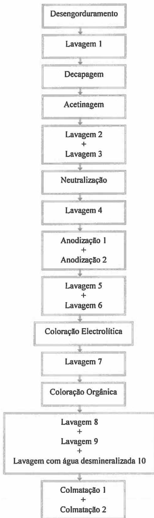
Figura II.5. – Exemplo de uma instalação típica de anodização (APAL, 1995).
