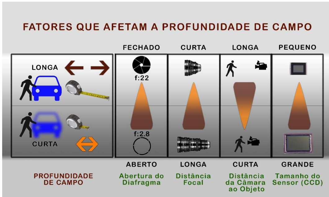
Figura 3 – Profundidade de campo consoante as quatro variáveis: abertura de diafragma, a distância focal da objetiva, a distância da câmara ao objeto e o tamanho do ccd.
