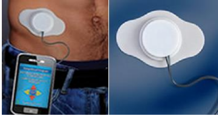
Figura 14 - Apresentação do U-Strip™, composto por um controlador de ultrassons e adesivo (adaptado de Transdermal Specialties, 2013).
