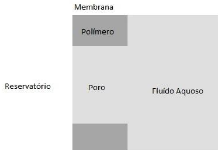
Figura 4 – Representação esquemática de um sistema reservatório utilizando-se uma membrana porosa (adaptada de Rathbone e Gurny, 2000)
