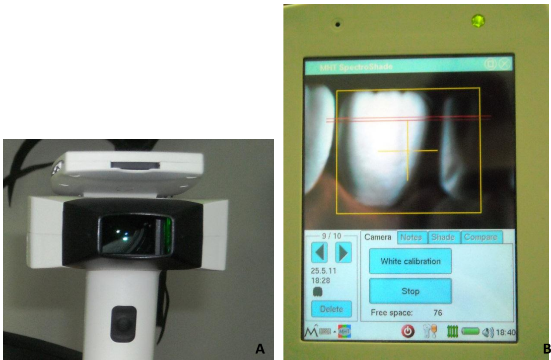
Fig. 21: A – Luz dirigida ao dente a 45°. B - A imagem do dente é exibida no ecrã do dispositivo, de modo a que o posicionamento possa ser verificado.
