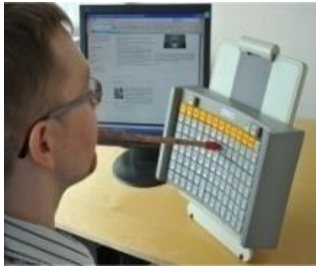
Figura 4. Teclado colmeia (para pessoas com déficit e/ou deficiência motora e espacial)
