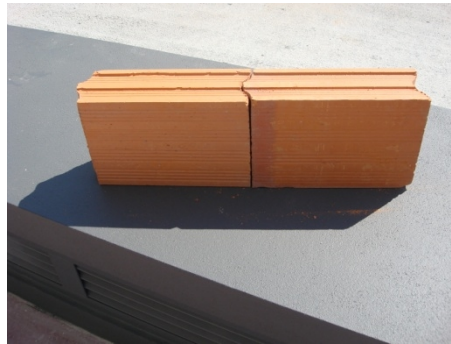
Figura 10 – Tecnotijolo 30x20x11 (Fonte própria. Fevereiro, 2009).
