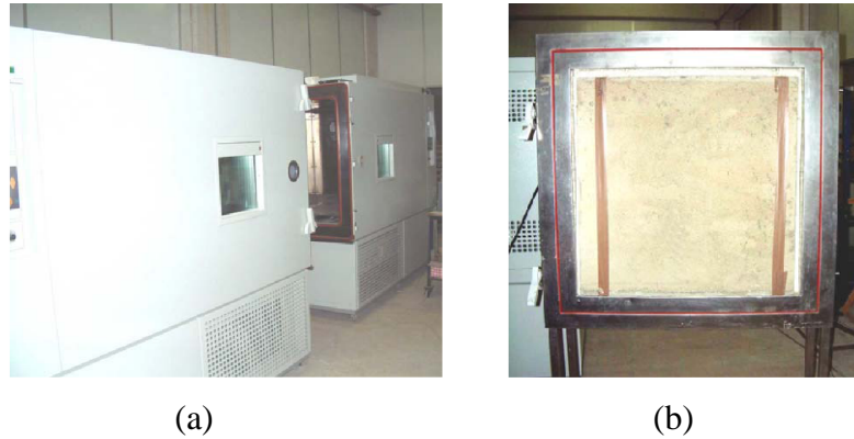
Figura 13 - Ensaio do comportamento acústico; (a) Câmara climática; (b) Parede de ensaio (Fonte: Construcer (a), 2005).
