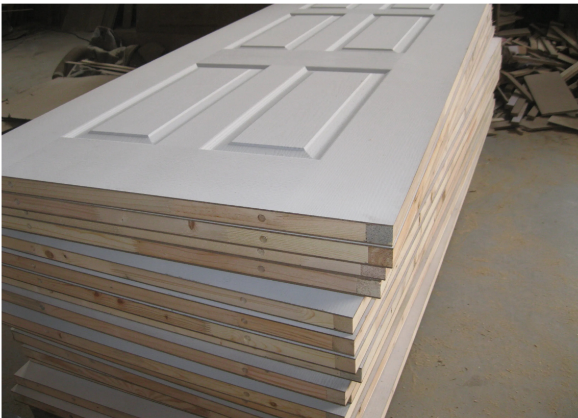
Figura 52 - Uso de HDF no fabrico de portas interiores
