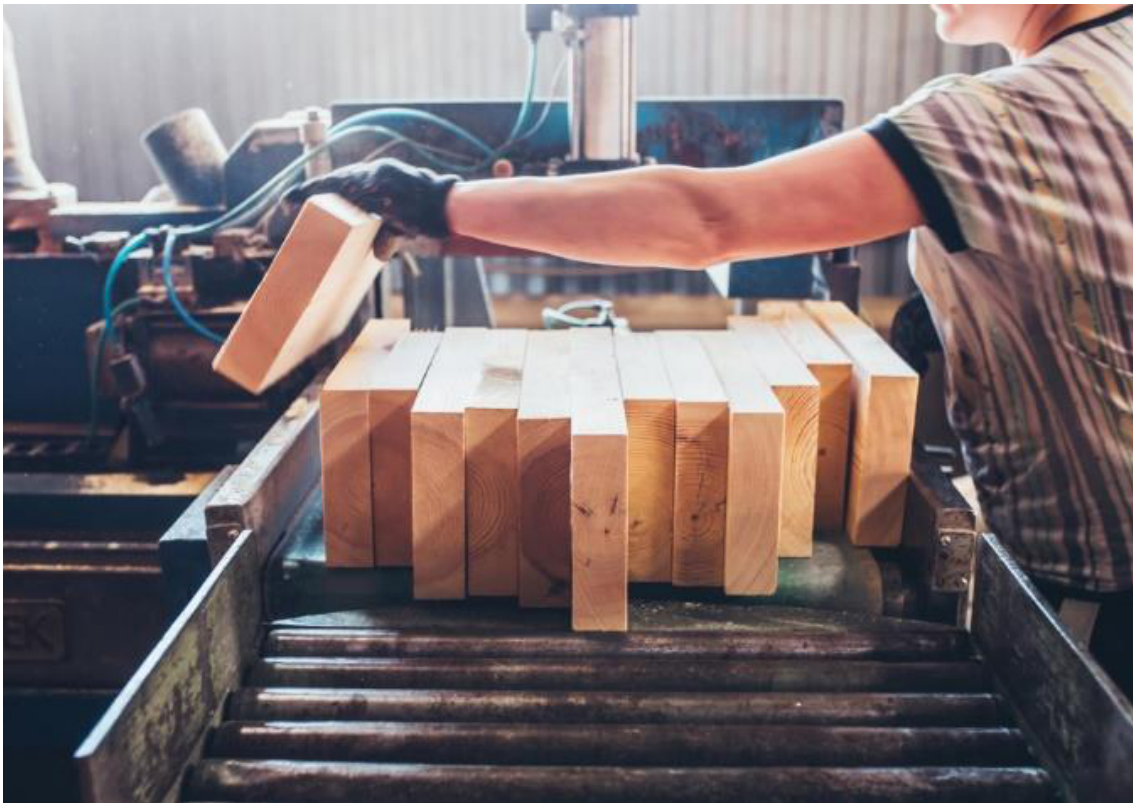
Figura 05 - Laminação da madeira - MLC
