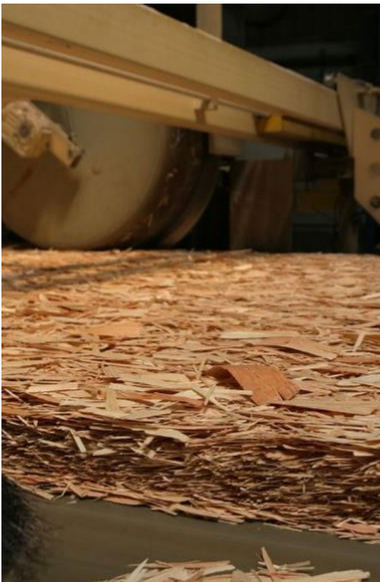
Figura 09 - Fabrico do OSB
