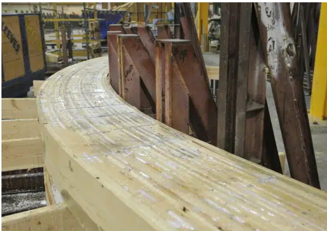
Figura 35 - Colagem de uma viga MLC em forma curva
