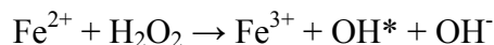
Fig. 15. Reacção de Fenton: decomposição do \text{H}_2\text{O}_2 dependente do ferro, com a produção de radicais hidroxilo muito reactivos (Zatta et al., 2009).
