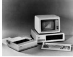
[1981] IBM PC A IBM lança o seu primeiro computador pessoal com um teclado de 83 teclas que tinha 10 teclas de funções e um keypad numérico.
