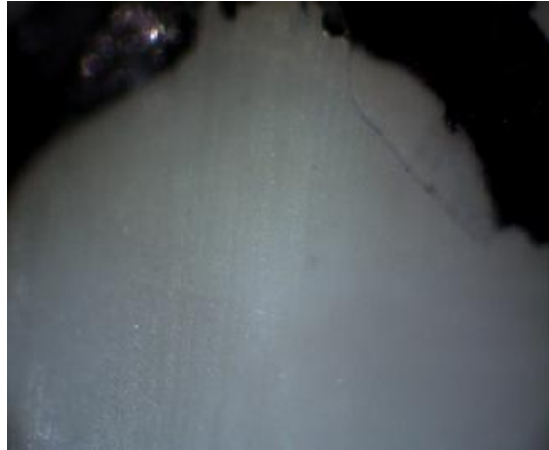
Figura 20 – Menos de 10 % de adesivo remanescente permaneceu no dente (Exemplo: Dente 2BD).
