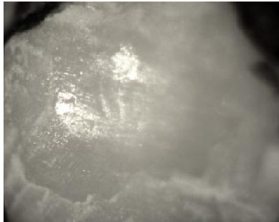
Figura 19 – Mais de 10% e menos de 90% de adesivo permaneceu no dente (Exemplo: Dente 20BD).
