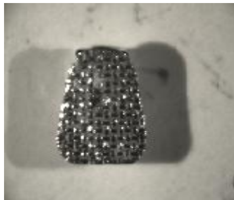
Figura 13: Base de braquete de aço inoxidável para incisivos mandibulares após descolagem (Miniormesh TW Loant, Ormco TM ).
