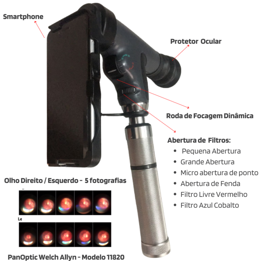
Figura 4.5: Exemplo do oftalmoscópio panoptic Welch Allyn .
