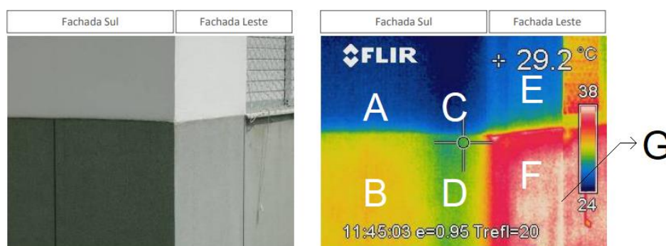
Figura 31 – Interferência da cor em um termograma. Fonte: adaptado de (Lamberts, s.d.).
