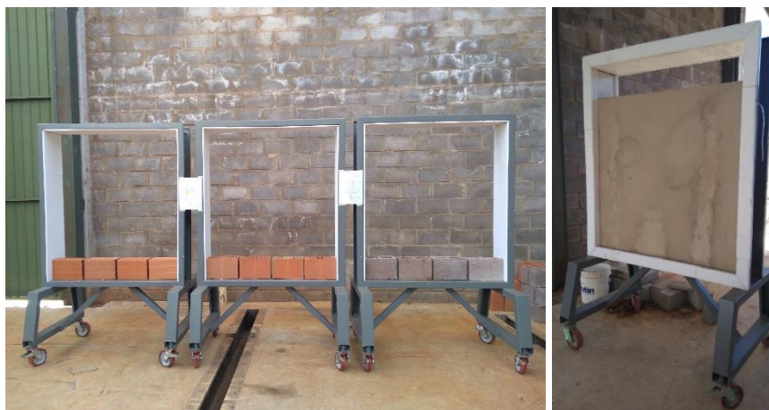
Figura 57 – Proteções térmicas das muretas de ensaio. Fonte: o autor.
