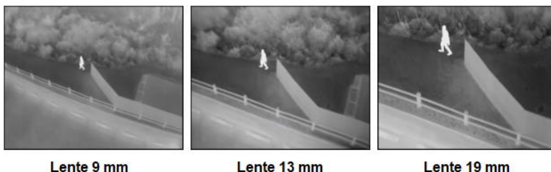
Figura 35 – Comparação de termogramas com uso de diferentes lentes.
