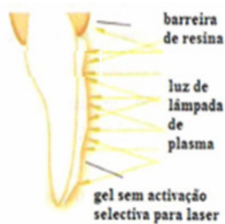
Figura 9 – Os aparelhos de luz usam uma pequena percentagem de energia luminosa, o resto da energia é desperdiçada em forma de calor
