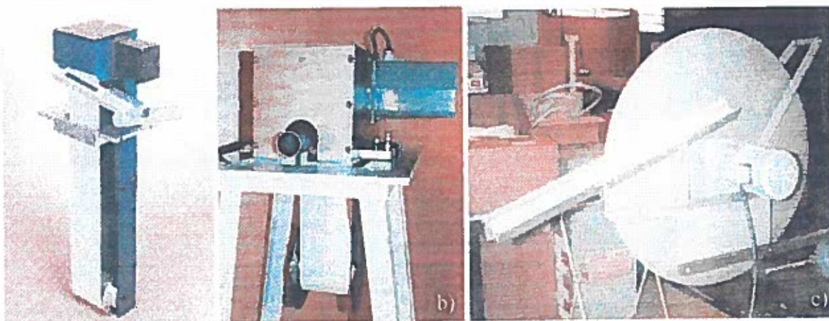
Figura G.5.- Desoleadores, a) e b) fita, c) banda, adquirido pelo CATIM no âmbito do projecto Recycle .
