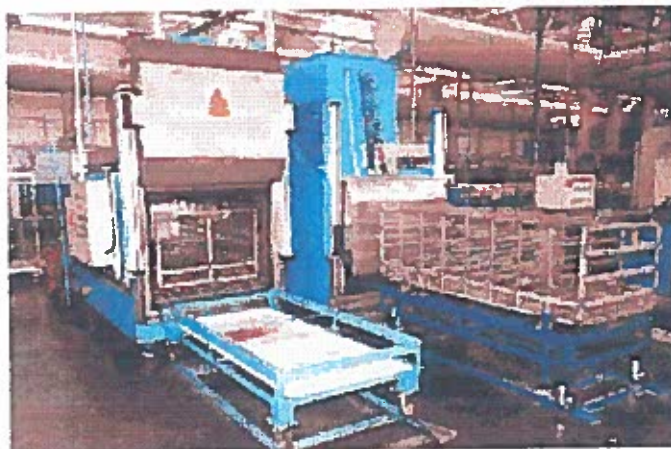
Figura III.16. – Sistema de limpeza com solventes a vapor em ambiente fechado ( http://www.parts-washing-cleaning-
