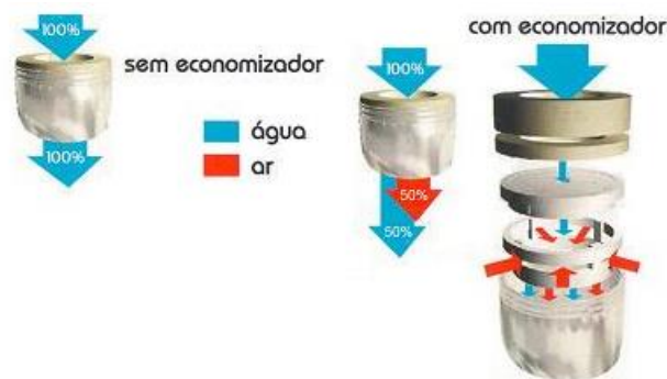
Figura 14 - "Esquema de funcionamento de um economizador de água" (Ecofree, 2015)
