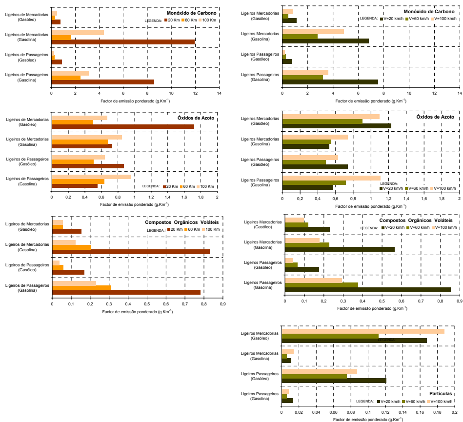
Figura 3 – Factores de emissão ponderados para os veículos ligeiros de passageiros e mercadorias tendo em conta o tipo de combustível (gasolina/gasóleo) para os diferentes gases (CO, NO x , COV e PM) calculados em função da metodologia EMEP/CORINAIR (gráficos da esquerda) e da metodologia NAEI (gráficos da direita), considerando uma velocidade média de circulação para três tipos de estradas representativos: estradas urbanas 20 Km.h -1 , estradas rurais 60 Km.h -1 e auto estradas 100 Km.h -1 .
