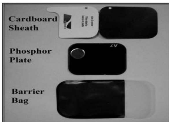
Figura 4. Componentes do Op Time, sistema de recepção de imagem (adaptado de kalathingal et al. 2009).
