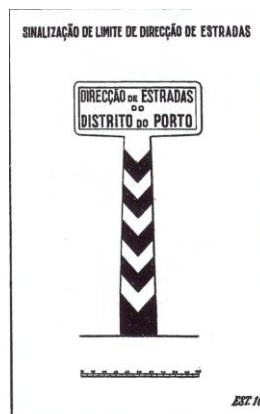
Figura 19 - Placa de sinalização de limite da Direcção de Estradas
