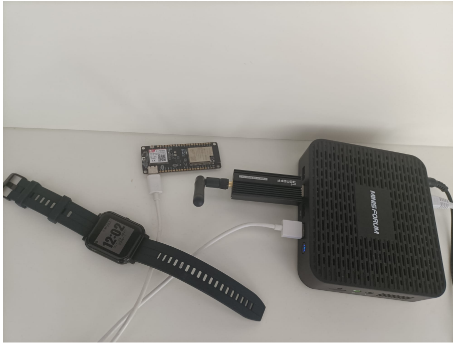
Figura 4.10: Representação esquemática da montagem do Sistema de Análise de Dados de Saúde e Bem-Estar.
