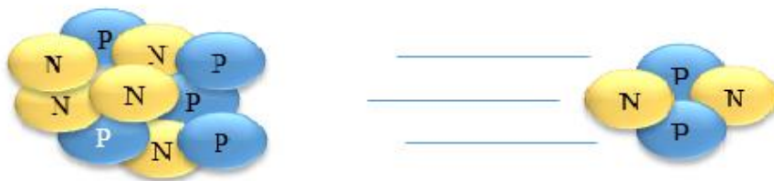
Figura 2 - Esquematização da libertação de uma partícula alfa. (N: neutrões e P: Protões). (Adaptado de https://www.mirion.com/introduction-to-radiation-safety/types-of-ionizing-radiation/ )
