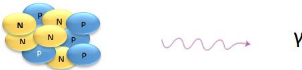
Figura 4 - Esquemática da libertação de um fóton. (N: neutrões e P: Protões) (Adaptado de https://www.mirion.com/introduction-to-radiation-safety/types-of-ionizing-radiation/ )
