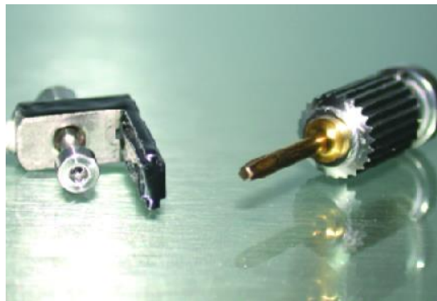
Figura 9- Transdutor e chave para aperto ao implante ou pilar (Ref. http://www.clitrofa.com/PublicacoesCientificas/Implantologia/Osstell.pdf ).
