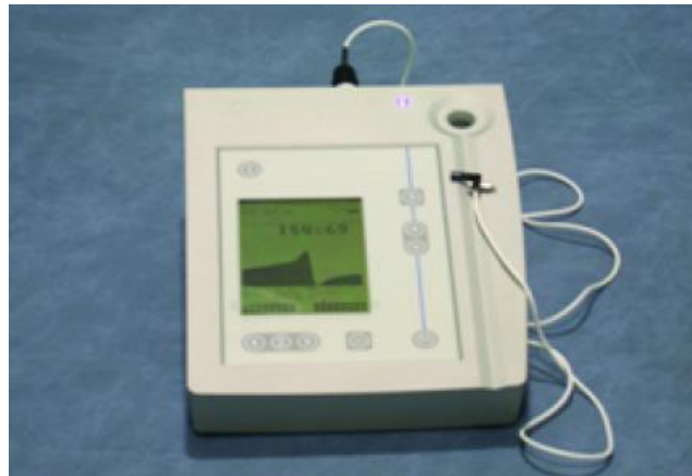
Figura 8- Aparelho Osstell ® com Análise de Frequência de Ressonância (Ref. http://www.clitrofa.com/PublicacoesCientificas/Implantologia/Osstell.pdf ).
