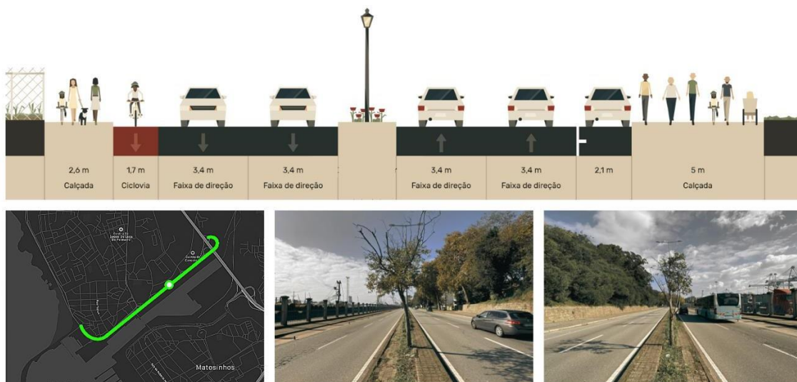
Figura 29 – Av. Antunes Guimarães / Perfil C - C' / Enquadramento: Via - 20 a 30 metros
