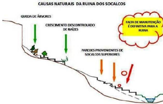
Ilustrações 47 e 48: Esquemas gerais de causas de ruína nos socalcos
