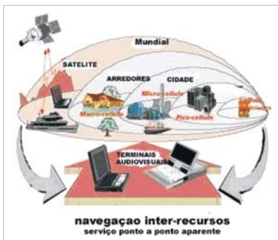
Figura 1: arquitectura do sistema UMTS (fonte: UMTS FORUM, in http://www.umtsforum.net/ )
