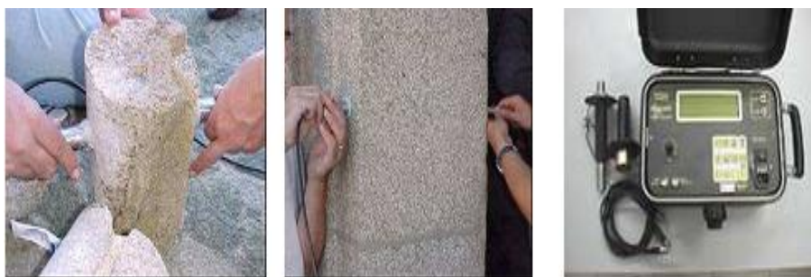
Figura 30 - Ultrassons (Fonte: C. Almeida, Faculdade de Engenharia da Universidade do Porto, 2013)
