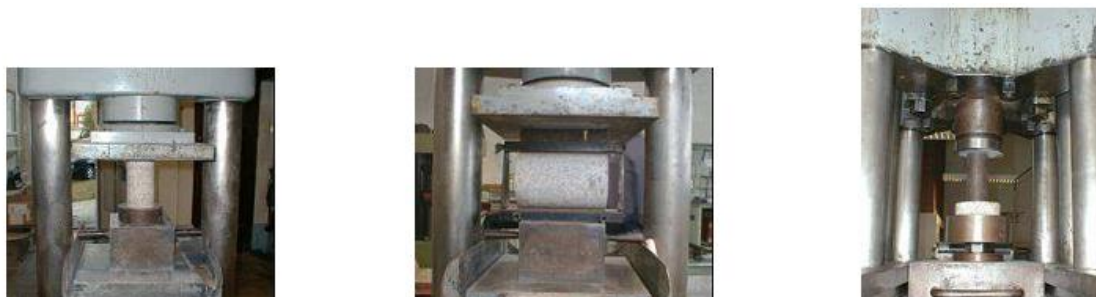
Figura 31 - Ensaios destrutivos para a pedra de granito (C. Almeida, Faculdade de Engenharia da Universidade do Porto, 2013)
