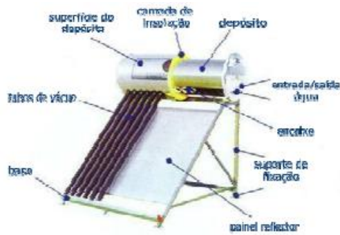
Figura 27 – Esquema de um coletor solar a vácuo (Fonte: Martino, 2009, p.1)
