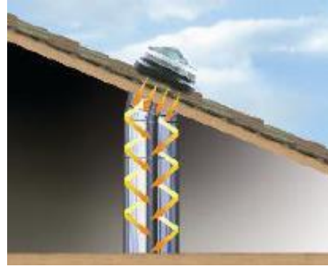
Figura 75 - Exemplo do funcionamento do tubo de luz solar (Fonte: GreenTubes, 2012, p.11)
