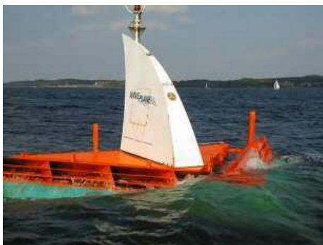
Figura 12 - Dispositivo nearshore de obtenção de energia das ondas (spill over) (Fonte: Barros, 2008)
