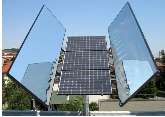
Figura 21 – Sistema fotovoltaico com superfície de reflexão
