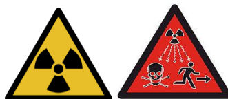
Figura 2.2 – Símbolos para a presença de radiação ionizante. Símbolo para uso em fontes radioativas extremamente perigosas
