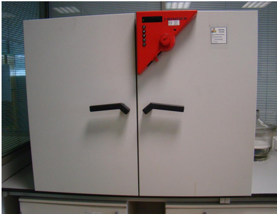
Fig. 13: Estufa Incubadora (Binder®) utilizada para a evaporação da solução irrigante existente nos Tubos de Eppendorf.
