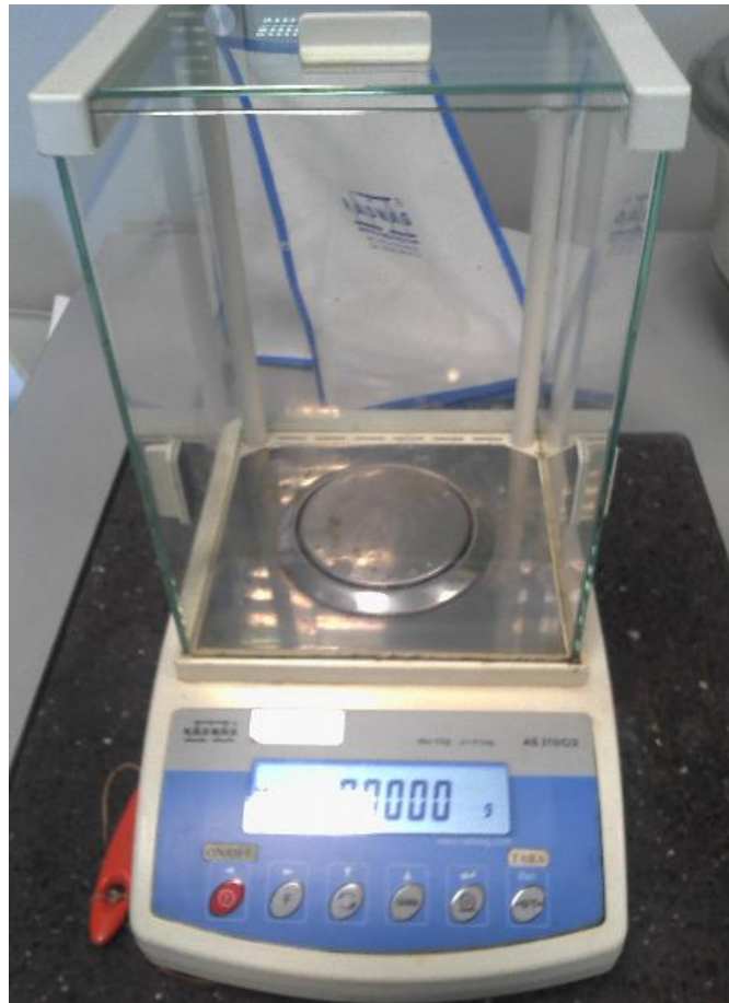
Fig. 16: Balança Analítica de Precisão (AS 310/C/2, da Radwag®) utilizada para efectuar as pesagens iniciais e finais de cada Tubo de Eppendorf.
