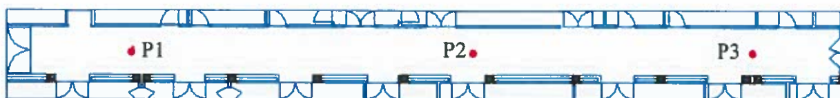
Figura II. 5. Pontos de medição do ruído no Corredor.
