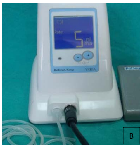
Figura 4: A. Peça de mão utilizado no sistema de instrumentação mecanizada SAF®. B. Dispositivo de armazenamento das soluções irrigadoras (VATEA®) (adaptado de Adigüzel, 2011).
