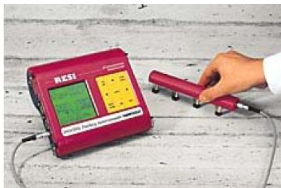
Figura 26. Medidor de resistividade do betão (Mendonça, 2005)
