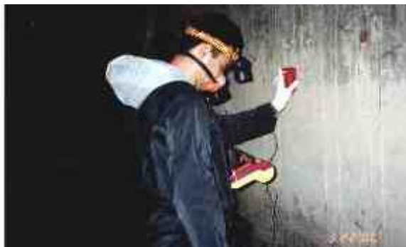
Figura 22. Ensaio de medição da espessura de recobrimento (Aguiar, 2006)
