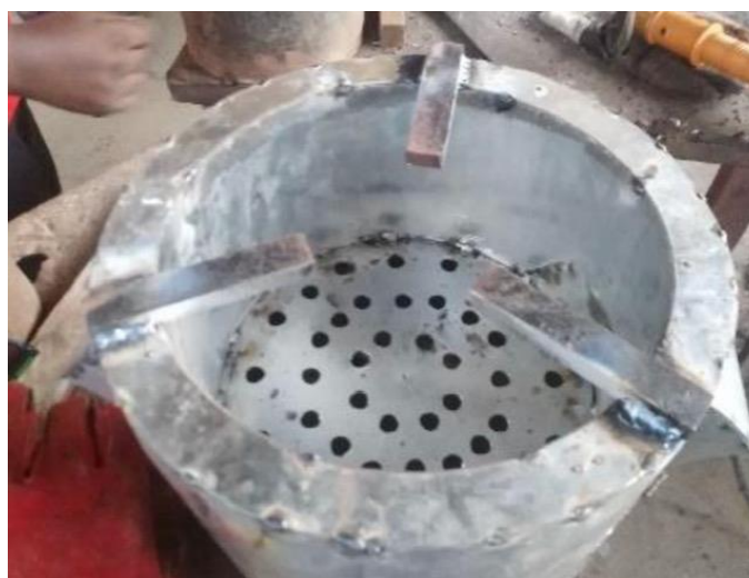
Figura 36 – Fogareiro ecológico para uso dos briquetes, elaborado pelas comunidades.
