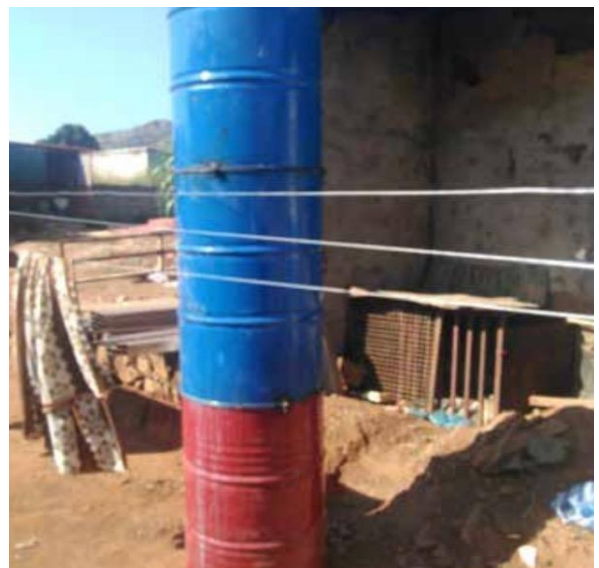
Figura 48 - Chaminé de um forno de briquetagem.
