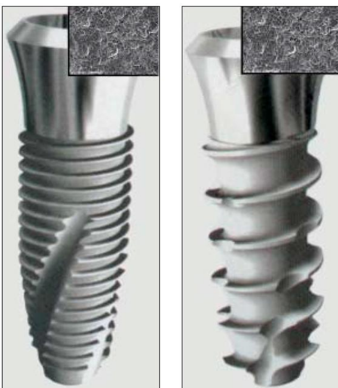
Figura 16 – Desenhos esquemáticos dos implantes testados. Esquerda Implante NP; Direita: Implante WP. Ambos apresentam ranhuras longitudinais ao longo do corpo do implante como característica adicional.
