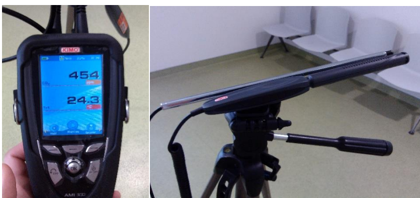
Figura 8: Aparelho KIMO AMI300, com o sensor de CO 2 , Temperatura e Humidade.
