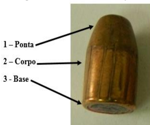
Figura 19 – Partes de Projétil
