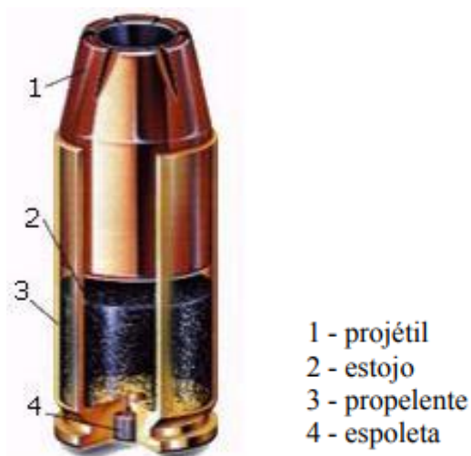
Figura 18 – Cartucho e seus componentes
