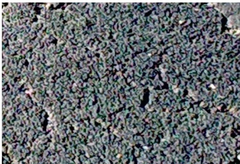
Figura III. 5 - Preenchidas com Micro betão (0/10)
