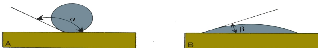
Figura 1 Esquema representativo do ângulo de contacto e da energia de superfície. Adaptado de Planas et alii 1996.
