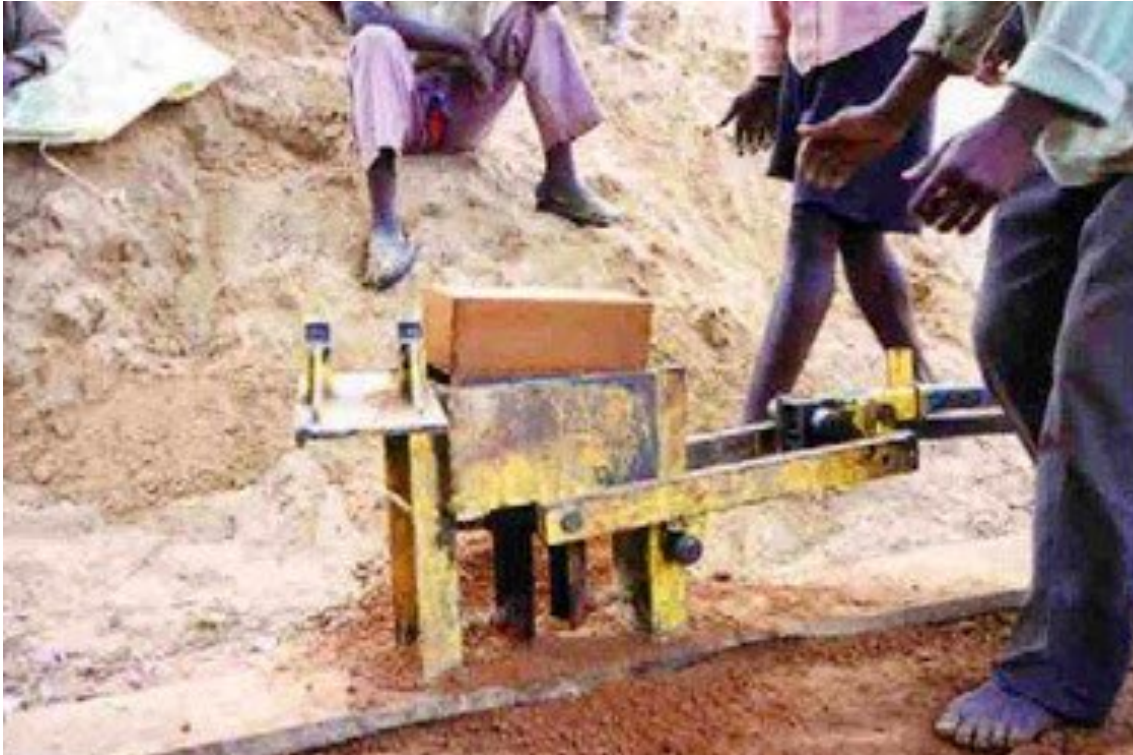
Figura 25 | Um dos métodos artesanais de produção de BTC.
