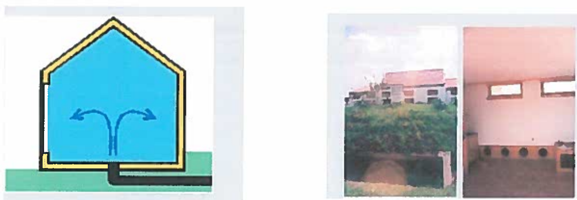
Figura 3.1-1 Esquema e exemplo prático de arrefecimento utilizado o Solo
