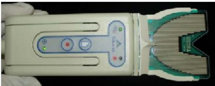
Figura 2: Aparelho T-Scan III com os sensores de 100 µm (Adaptado de Trpevska, et al. , 2014)
