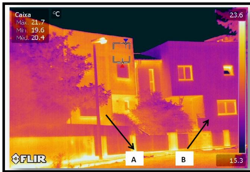
Figura 1.16 - Imagem Termográfica de duas habitações; fonte: Eng.º António Cardoso
