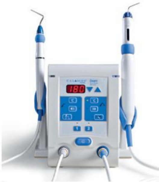
Fig. 5 – Unidade termoplástica Calamus® para aquecimento e injeção de GP. (Adaptado de: Hargreaves, K.M., Cohen, S. & Berman, L.H., 2016. Cohen's pathways of the pulp , 11th ed.)
